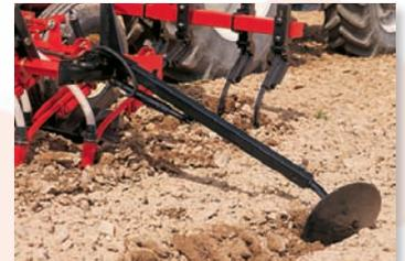
▲ -Hydraulic marker. / Traceur hydraulique.
