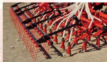
▲ -Adjustable back harrow in depth and pressure. / Herse arrière réglable en profondeur et pression.
