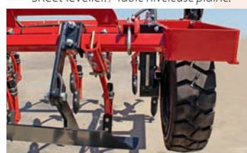
▲ -Depth control wheels on the sides. / Roue de contrôle de profondeur sur les latérales.
