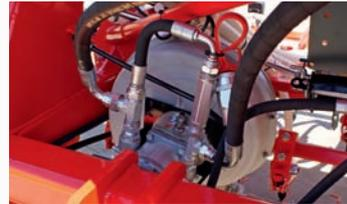
▲ -Turbine with hydraulic engine. / Turbine à moteur hydraulique.
