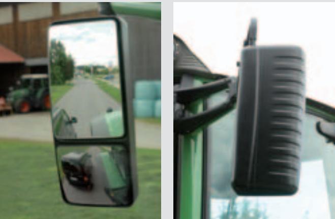
Широкоъгълно огледало за по-голяма видимост Опционалното широкоъгълно огледало предлага значително по-голяма сигурност с разширеното поле на видимост. Вашето ползрение се разширява точно за това, което става в страничната част на трактора. Зоната на опасност, която иначе се намира в областта на спялата точка, сега е с много по-добра обзоримост, с което могат да бъдат избегнати непредвидени ситуации.
