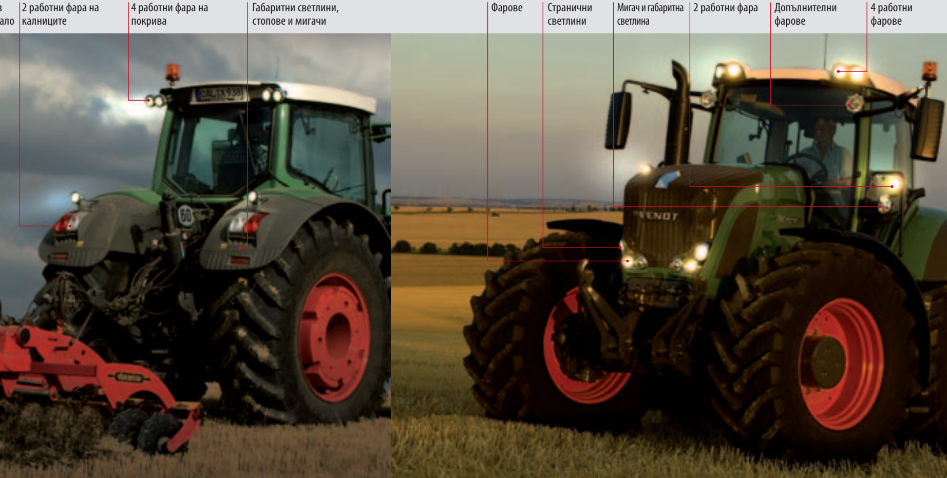
Поглед върху всичко, дори и в тъмното С гениалната си концепция на осветление 900 Vario не ви оставя на тъмно. Силата на осветление с отражателни, както и с дълги светлини, е на уникално високо ниво. Работното осветление на 900 Vario може да се регулира индивидуално на 360 градуса. Опционално могат да се доставят и ксенонови фарове.
