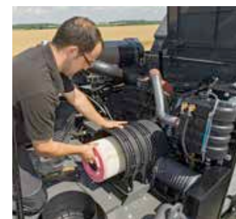
Чист въздушен филтър
