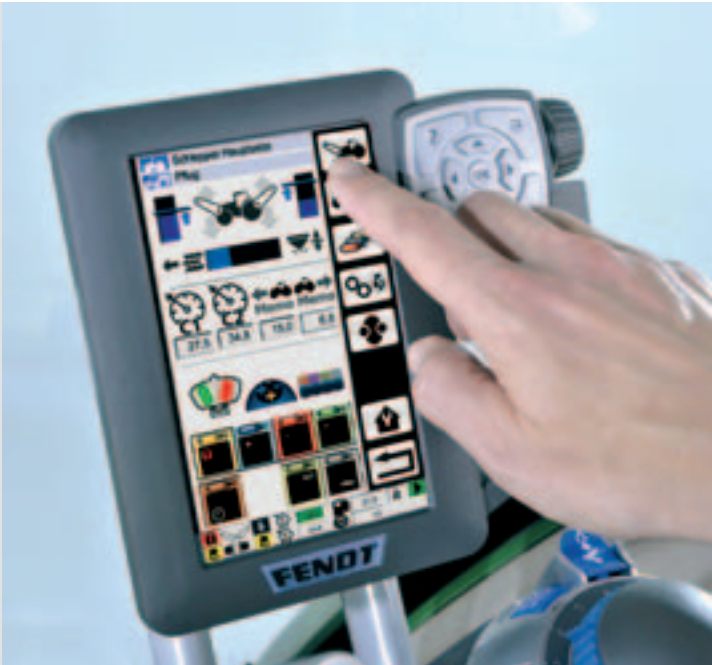
Vario-терминал 7" Vario-терминалът 7", с диагонал на дисплея 17,7 сантиметра, е удобният и функционален вариант за управление на трактора и на инвентара Variotronic.
