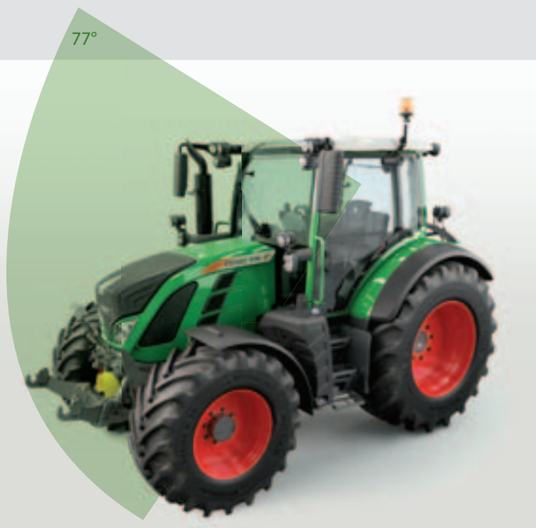
Ъгълът на видимост нагоре е утроен. И надолу линиите на видимост са оптимизирани и много добре се вижда хода на колелата.
