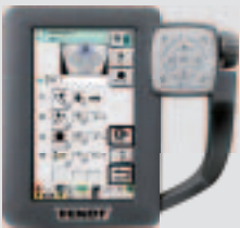
Система за управление на инвентара Variotronic™ В системата за управление на инвентара Variotronic™ водачът задава в покой или по време на движение процеса на обръщане и го запазва. Стъпките на сентенцията се показват във форма на време или дистанция. Отделните стъпки могат да се коригират.
