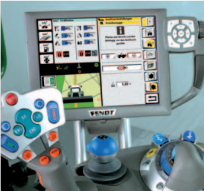
Vario-терминал 10.4" С Vario-терминала 10.4" няма неизпълнени желания. Днес от него се управляват както трактор и инвентар, така и екстри като камера, навигация на FENDT и документационна система.
