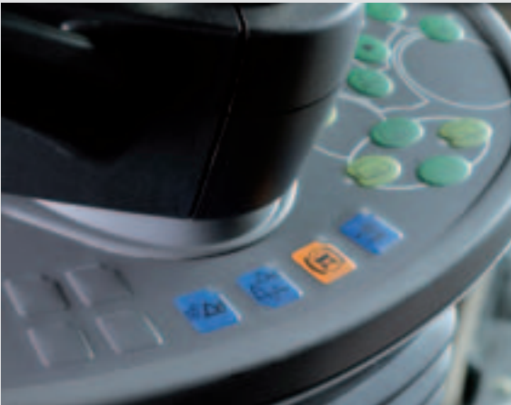
Бутони за хидравлично заключване на инструментите и активиране на демферирането.
