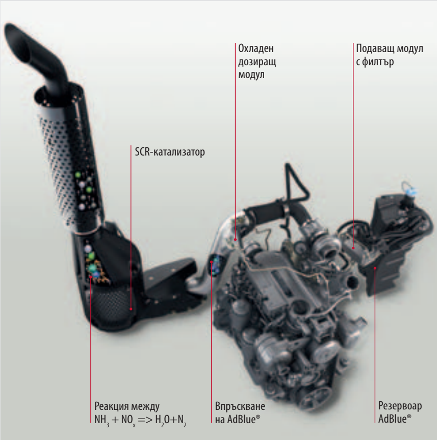
SCR (Селективно-каталитична реакция) за неутрализиране на изгорелите газове При технологията SCR отработените газове се преобразуват посредством AdBlue®, 32,5-процентов разтвор, като азотните оксиди NO x се превръщат в безвредните азот и вода. Употребата на тази течност при камионите възлиза на средно на 7 процента от разхода на гориво. Според вида работа тази стойност варира. AdBlue® може да се закупи навсякъде по бензиностанциите или чрез AGCO Parts.
