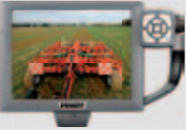
Показване на камера Големият Vario-терминал 10.4" предлага свързване с до две камери. По този начин се повишават значително комфортът и сигурността.
