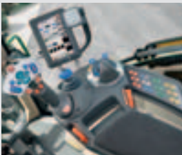
Интелигентно управление Управлението на клапаните става практично от кръстатия лост и от мултифункционалния джойстик.
