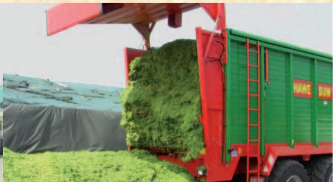
Als Option wird auch eine Schnellentladung im Heck mit speziellem Antrieb angeboten. Dadurch können die HAWE SUW auch als Häckselwagen in der Mais- und Grasernte eingesetzt werden.
