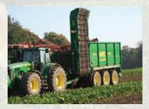
Der Bunker des HAWE RUW ist so konstruiert, dass die Rüben schnell und ohne Verluste während der Fahrt überladen werden können. Beide Fahrer haben alles im Blick.
