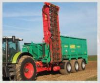
Die großvolumige Bereifung verringert den Zugkraftbedarf und vermeidet Bodenverdichtungen auch unter nassen Erntebedingungen.
