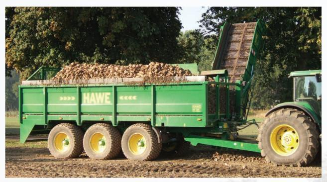
Der Spezialist für Überladewagen, HAWE Wester, bietet Rübenüberladewagen mit 27 und 40 Kubikmetern Bunkerkapazität an. Das Volumen ist abgestimmt auf die selbstfahrenden Bunkerköpfroder. Die HAWE RUW nehmen die Rüben während der Fahrt problemlos
