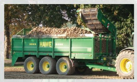
Das Förderband wird hydraulisch geklappt und verringert so die Fahrzeughöhe.
