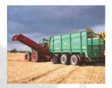
Das weit ausladende Förderband des HAWE Rübenüberladewagens legt die Zuckerrüben schonend, schnell und sauber auf dem Mietenlagerplatz ab. Der Fahrer hat einen guten Überblick, da das Band vorn am Wagen angebaut ist. Die transparente Stirnwand des RUW ermöglicht einen guten Blick in den Wagen.
