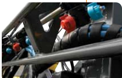
Жиклеры и форсунки защищены внутри структуры штанги, чтобы избежать контакта с землей или другими препятствиями. Имеются жиклеры "trijet-quadrjet-pentajet" и форсунки с противокапельной системой и с зажимным кольцом быстрого крепления.
