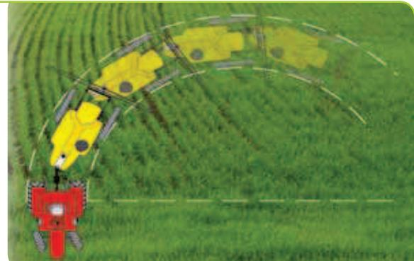
**"Trailmatic"** Руль управления "Trailmatic" с электронным обеспечением посредством датчика подсоединеного к буксируному крюку. Управляется электроклапанами цилиндра, подсоединеного к трактору, позволяющими опрыскивателю идти по следам трактора. Возможность блокирования в течение продвижения и обработки.
