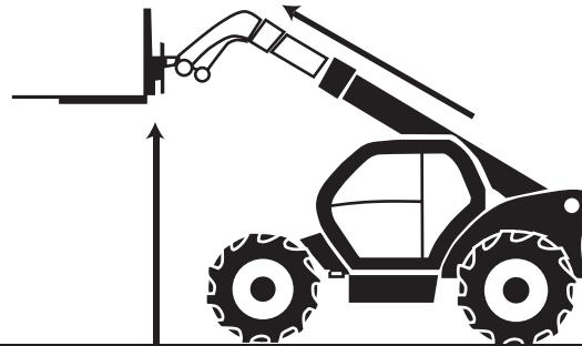
**1. „Quicklift“:** за автоматично извършване на две движения (повдигане/сваляне + движение на телескопа) за улесняване на складови операции.
