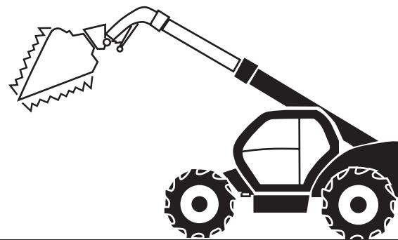
**2. Разтърсане на кофата „Bucket Shaker“:** бързо изпразване на кофата без нужда от повторни движения. Вече няма да остава полепнал материал подъното на кофата.
