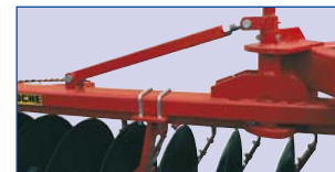
Zusätzlich verstrebt Segmente mit Zugausgleich
